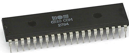
Fig. 3 - La CPU MOS 6510 (autore: Konstantin Lanzet - fonte: Wikimedia Commons)
