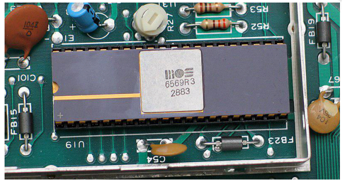
Fig. 4 - Il MOS VIC-II, chip grafico del C64 (foto: Christian Taube - fonte: Wikimedia Commons)
