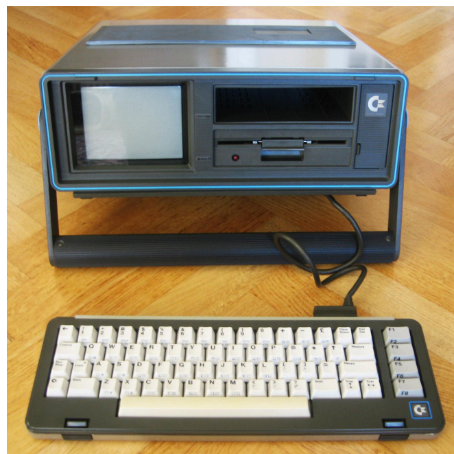
Fig. 9 - Il Commodore SX-64, una versione "portabile" del C64 (foto: Hedning - fonte: Wikimedia Commons)
